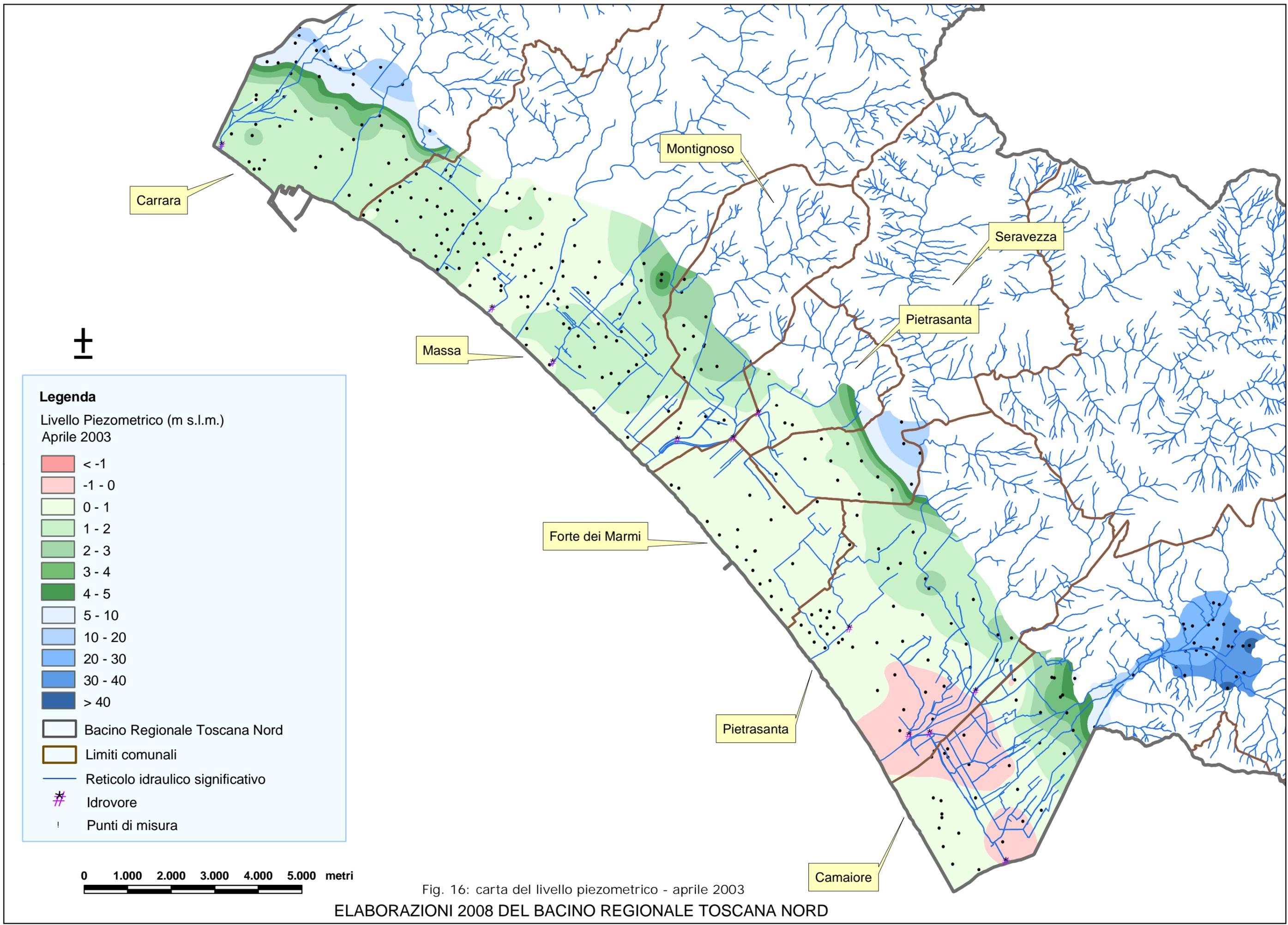
Fig. 16: carta del livello piezometrico - aprile 2003
