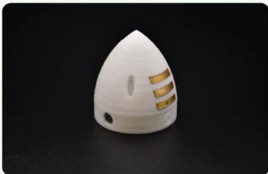
Dettaglio della punta della radice con sensori integrati
