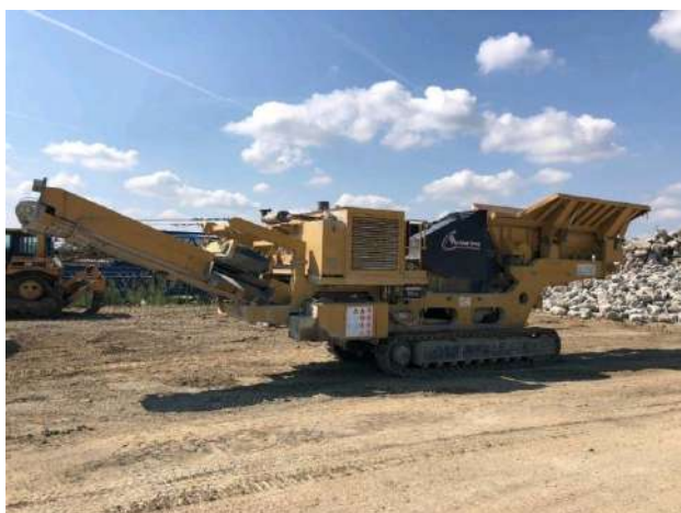
Figura 7: Esempio di Macchina con tramoggia abbassata e pronta per il trasporto.
