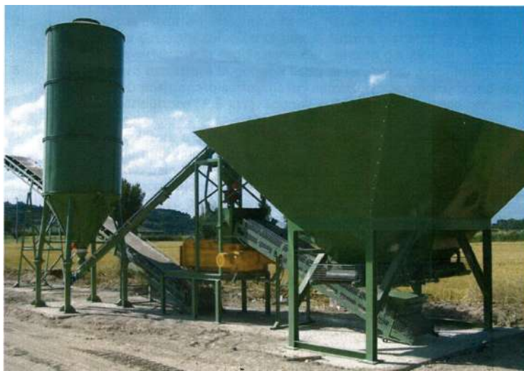
Figura 8: Centrale di betonaggio in continuo per inertizzazione di materiali di recupero.
