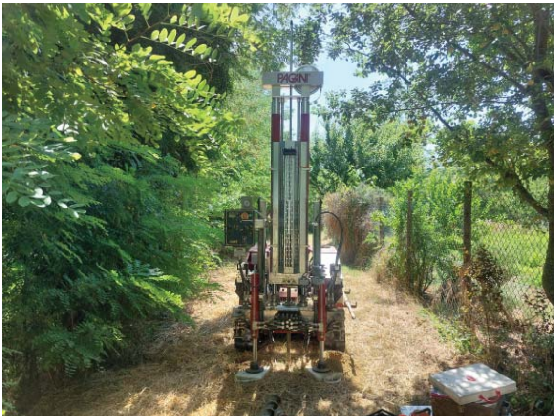
FOTO 1 : Strumentazione utilizzata per l'esecuzione della prova DPSH 11.
