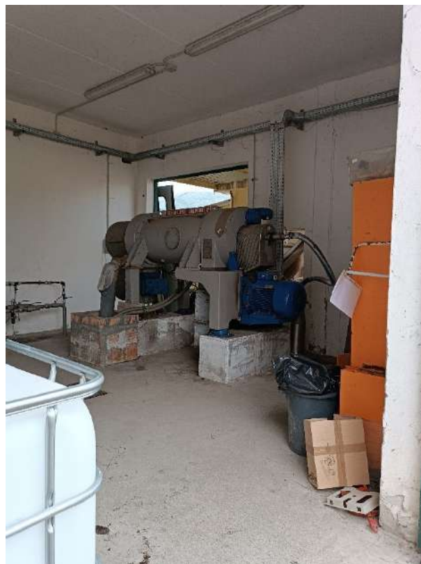
Figura 7 – Centrifuga all'interno del locale disidratazione fanghi
