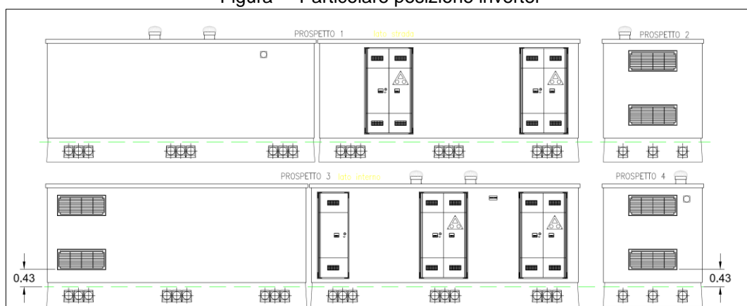
Figura – Particolare cabine di trasformazione
