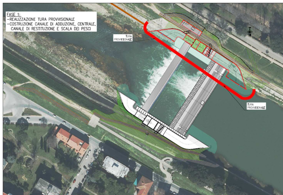
Figura 6 – Layout di cantiere – FASE 1.
