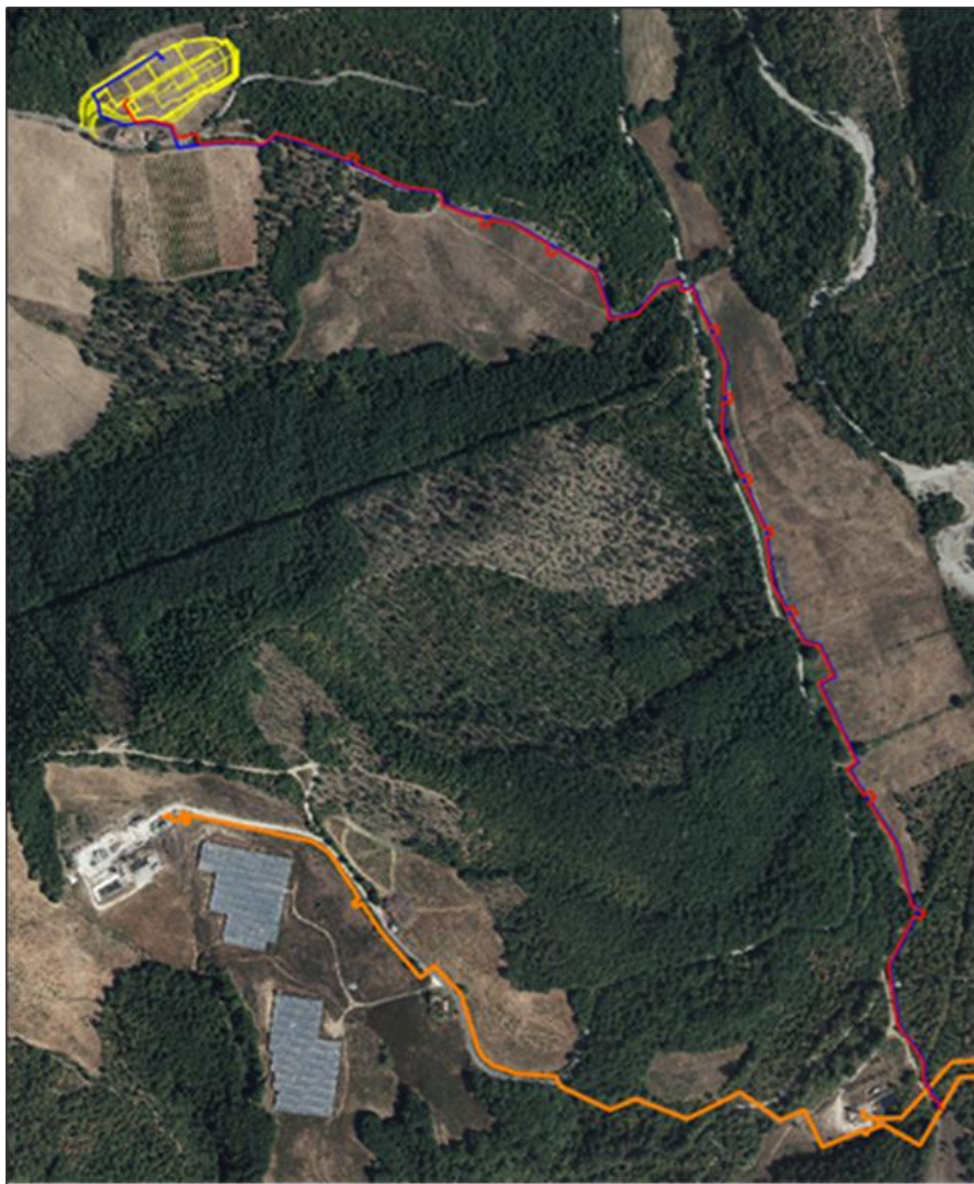
Figura 2-3: Radicondoli_36 - Opere a Rete – In arancione rete fluidi esistente; in rosso nuovo tratto di vaporedotto/bifasedotto; in blu nuovo tratto di acquedotto (sia quello di perforazione che quello dedicato al lavaggio del vapore).
